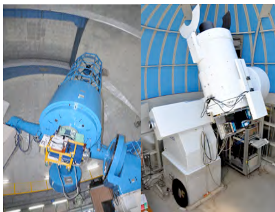
図1 岡山天体物理観測所188-cm望遠鏡と可視分光・撮像装置KOOLS(左)、50-cm望遠鏡と3バンド同時撮像カメラMITSuME(右)
