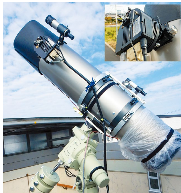
▲ 写真2. 25cm 反射望遠鏡（笠井トレーディング GINJI-250N）と冷却 CCD カメラ（SBIG ST-9E）。
