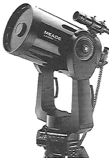
図3 Meadeの30cmシュミットカセグレン望遠鏡LX-200。
