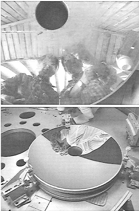
図3 再蒸着前の鏡(上)と再蒸着後の鏡(下)
